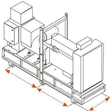
**ВНИМАНИЕ!** Перед тем как установить электростанцию и затянуть крепежные болты убедитесь, что бетон окончательно встал и затвердел.
