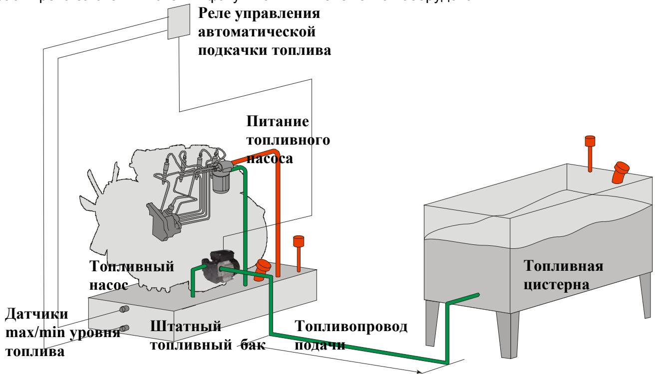
Топливоперекачивающий насос должен иметь достаточную пропускную способность для перекачки полного объема, необходимого для работы двигателя, то есть объем топлива, потребляемого топливом.
