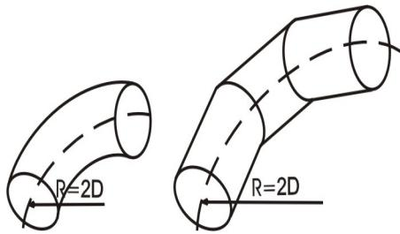
Выхлопные трубопроводы следует выполнять по возможности с минимальным количеством поворотов и изгибов. Следует помнить, что чем более извилистая выхлопная труба, тем больше мощности теряется и, следовательно, тем больше диаметр труб необходимо использовать, что, в свою очередь, утяжеляет конструкцию и влечет за собой удорожание опор и глушителей.
