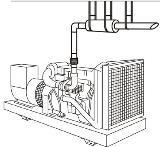
Если глушители или части выпускного трубопровода, находятся в пределах досягаемости персонала, следует защитить ограждением или изоляцией. Изоляция не только защищает персонал, но и снижает излучение тепла в помещение, а также понижает шум выпускной системы.
