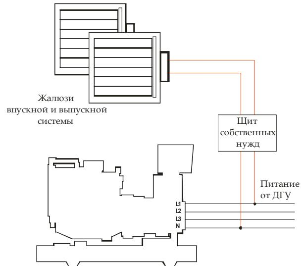
Как правило, при инсталляции ДГУ в отапливаемых помещениях вентиляционные отверстия оборудуются автоматическими термоизолированными жалюзи с электроприводом.
