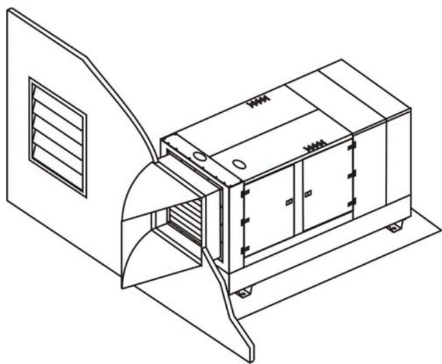
ДГУ в кожухе, монтаж впускных и выпускных жалюзей с одной стороны стены.
