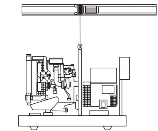
Это устройство облегчает перемещение генераторного агрегата. Оно располагается сверху по продольной оси генератора по направлению к выходу.
