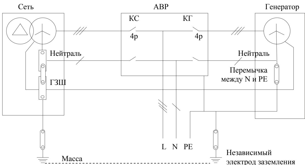
Все агрегаты компании GESAN снабжены контактами заземления в соответствии с международными стандартами. Точки места подключения заземления отмечены ярко различимыми ярлыкам и включают перемычки между силовым узлом и рамой установки или основанием шасси, между противовибрационными устройствами и основным шасси и между панелью управления и точкой заземления. Кабели выкрашены в желтый и зеленый цвета и
