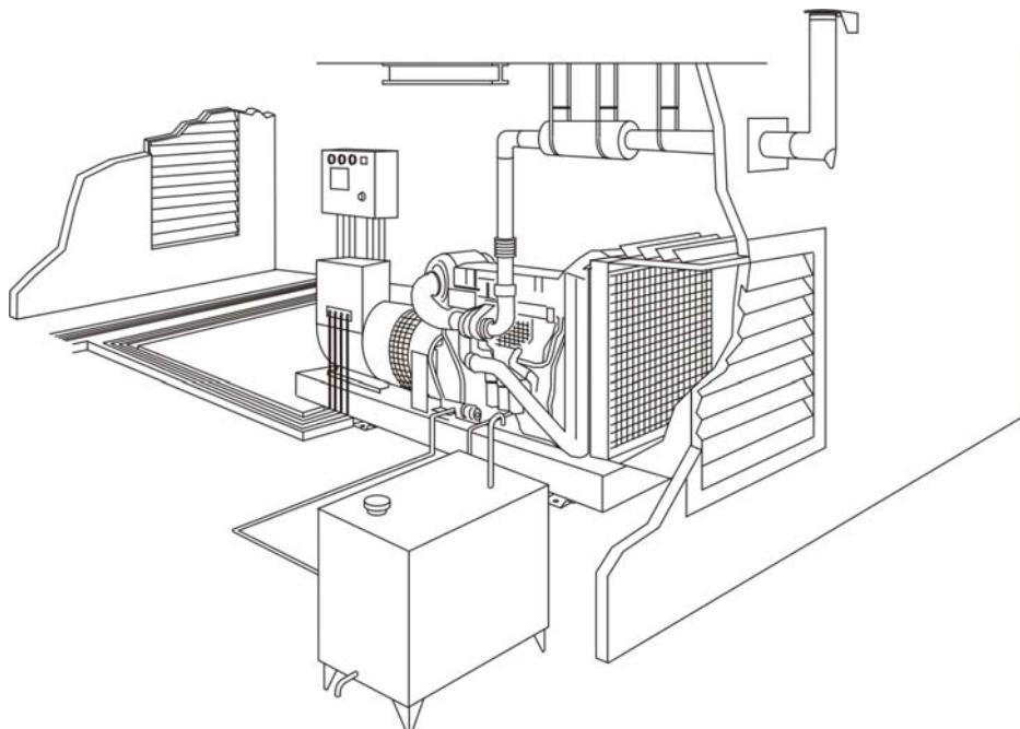
Дизель-генератор необходимо размещать с учетом удобства эксплуатации и ремонта. При этом следует соблюдать следующие минимальные расстояния от выступающих частей корпуса агрегата до ограждающих элементов зданий.
