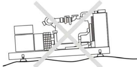
Фундамент под дизельный генератор должны выполняться согласно СНиП 2.02.05-87.
