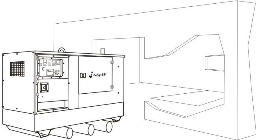
2 домкрата, 3 трубы диаметром 60 мм с толстыми стенками, равные ширине рамы.
