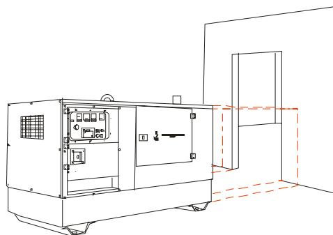
Для обеспечения возможности монтажа дизельного генератора и щитового оборудования следует предусматривать ворота или монтажные проемы, размеры которых должны, как правило, превышать габариты оборудования не менее чем на 400 мм., в противном случае, стоит предусмотреть строительные работы, если это возможно.
