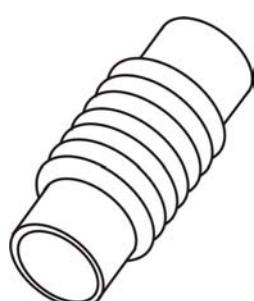
Следует использовать тепловой компенсатор или гибкую вставку между коллектором и первого зафиксированного участка выхлопной системой выхлопных трубопроводов, чтобы предотвратить передачу вибрации двигателя трубопроводу и зданию, а также изолировать двигатель и трубопровод от сил, возникающих вследствие температурного расширения, перемещения или веса трубопровода.
