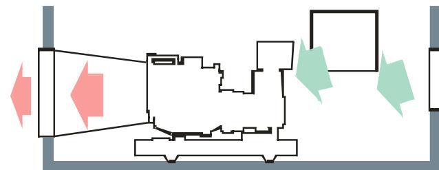
При недостаточной вентиляции температура в помещении будет расти, что повлечет за собой потерю мощности двигателя вплоть до полной остановки генераторного агрегата (в некоторых случаях необходимо предусмотреть дополнительную вентиляцию).
