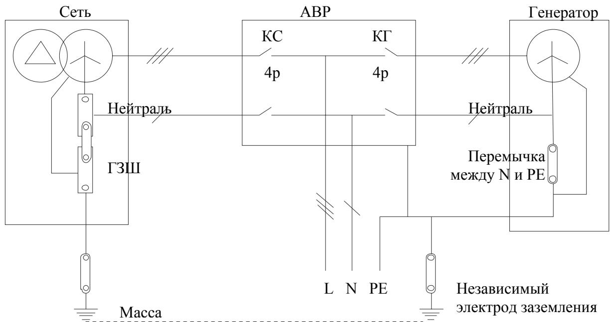
Генераторная установка для низковольтной зануленной сети с заземлением, представленным электрокомпанией (поставщиком сетевого питания), с четырехполюсным АВР со взаимной блокировкой и независимым заземлением генераторной установки
