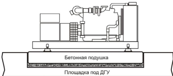
Поверхность земли или пола под ним должна быть правильно подготовлена и иметь структуру, способную выдержать вес фундамента с агрегатом. При выполнении расчетов нужно учитывать вес охлаждающей жидкости, масла и топлива в штатном топливном баке который интегрирован в раму ДГУ. Расчет осуществляется по следующей формуле:
