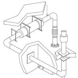
Вывод должен осуществляться только с использованием труб с толщиной стенки не менее 1,5 мм. Использование жестяных коробов или гофрокороба для монтажа газовых хлопа недопустимо.
