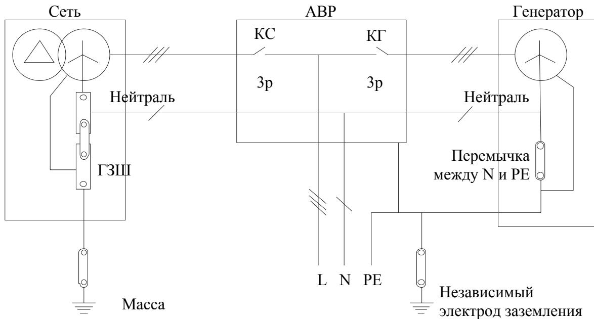
Генераторная установка для низковольтной зануленной сети с четырехполюсным АВР со взаимной блокировкой и независимым заземлением генераторной установки
